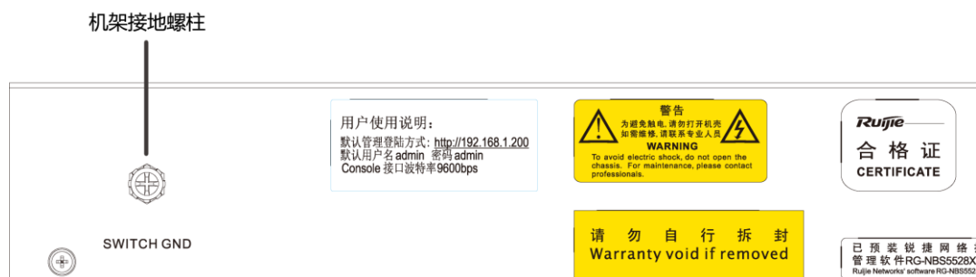
图2-1 RG-NBS552XG 系列交换机接地示意图
