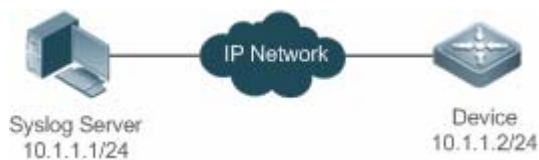
图 1-2 系统日志发送到日志服务器组网图
